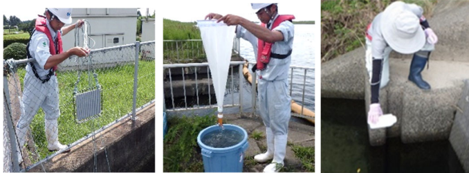
侵入を検知する様々な調査手法 (左：付着板、中：浮遊幼生の採取、右：環境DNA)
