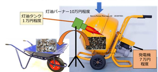
簡易燃焼装置の概要
