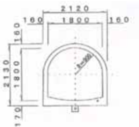
参考 2-12 幹線用水路(ずい道)標準断面図
