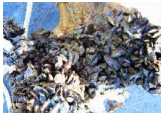
流量計のプロペラに付着したカワヒバリガイ（左：プロペラ全体、右：拡大写真）
