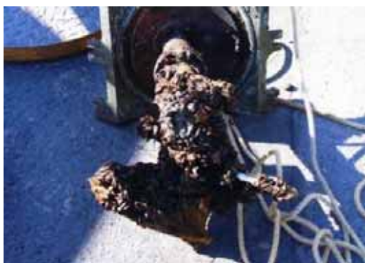
流量計のプロペラに付着したカワヒバリガイ（左：プロペラ全体、右：拡大写真）
