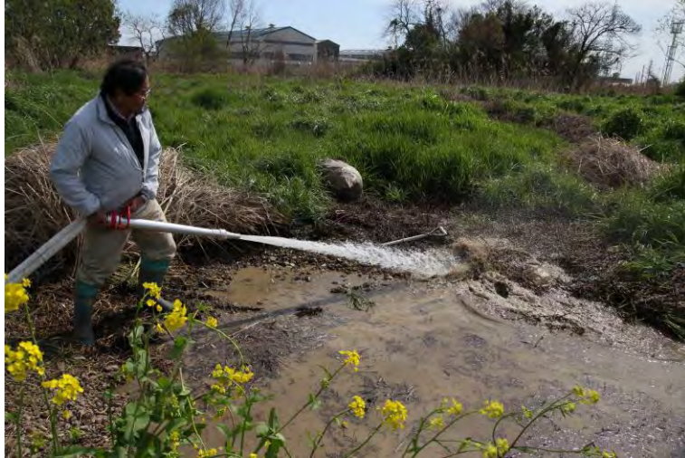
消防用ノズルの噴射による地下部掘削
