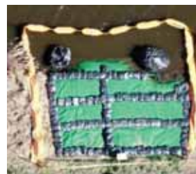
遮光シートによる被覆 左：水際陸部、右：水際水中部 （霞ヶ浦除去対策実験※）
