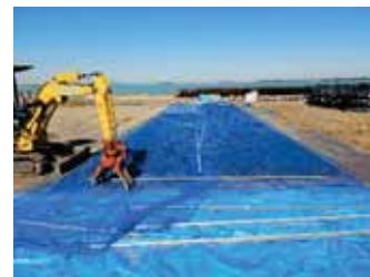
ロードローラーによる押しつぶしと ネットによる固定（霞ヶ浦除去対策実験※）
