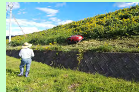
ラジコン式草刈機でため池法面の草刈りを実施
