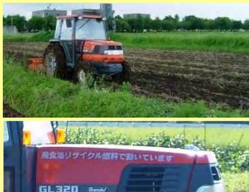
耕起作業のトラクターは、菜種油から製造されたBDFを燃料としている。
