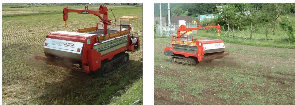
写真28 但馬牛の堆肥をマニアスプレッダで田畑へ散布し還元する
