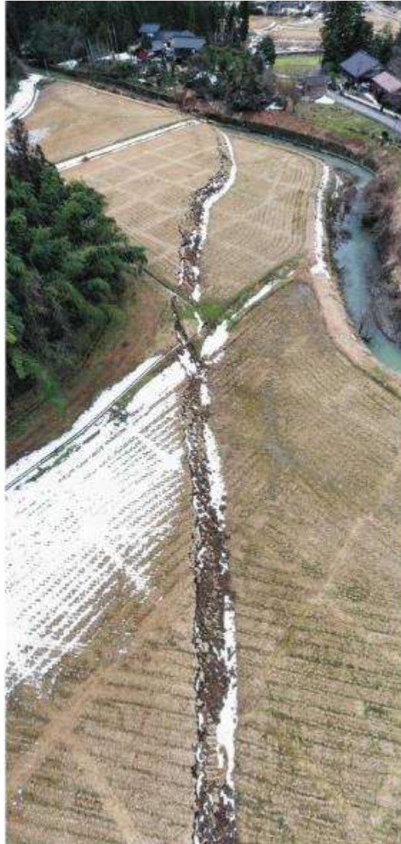
農地の亀裂・水路破損
