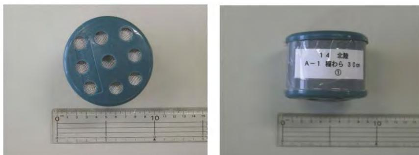
土壌改良資材については、1サンプルにつき、土壌：175gと資材：35gをそれぞれ計量し、葉さじ等で両者を混合したのち、上記のカプセルに収納し蓋をする。なお、暗渠疎水材については、1サンプルにつき土壌10gをカプセルの底部に敷き、その上にモミガラは20g、チップは30gをそれぞれ計量して土壌の上に置く（混合しない）。
