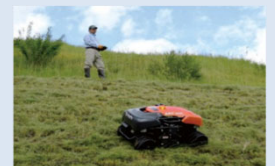
緩傾斜化法面における 無線遠隔草刈機
