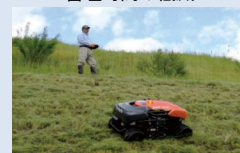
緩傾斜化法面における 無線遠隔草刈機
