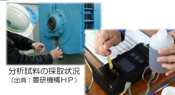
簡易診断装置による 潤滑油の劣化分析状況 (出典：農研機構提供資料)
