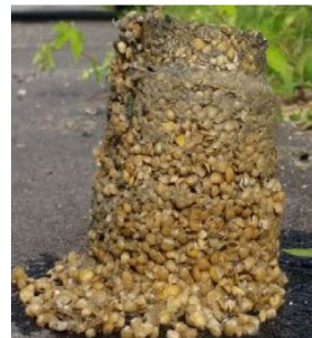
ストレーナーの詰まり
