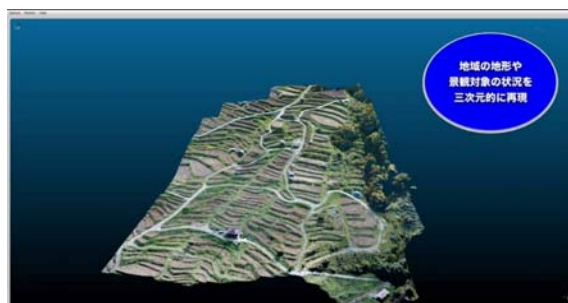
図7 三次元解析例（棚田の点群データ）
