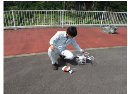
〔航法用センサーのキャリブレーション〕
