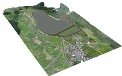
左の三次元点群データ（画像）に新設ため池の三次元モデルを組み合わせることで整備後のイメージを作成
