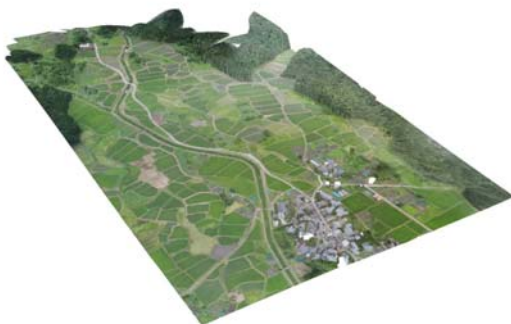
小型 UAV 空撮画像をもとに三次元点群データを作成し対象地域を再現
