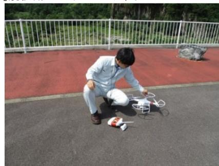
運航させる直前には、使用するUAV機体の状態について点検を行うことが重要であり、機体の外観に加え、ネジの締付状態、バッテリー状態、送信機の状態、カメラ、記録媒体の状態等の確認を行っている。このほか、UAV本体のマニュアル等に準じた確認も必要であるとともに、機体の航法用センサー等のキャリブレーション（イニシャライズ＝初期化）を行っている。
