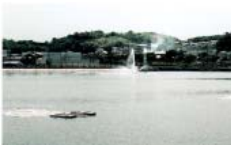
噴水による曝気と水流機（フロータイフ）による対流
