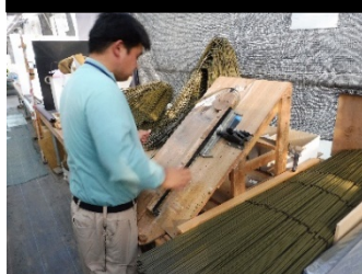
治具による支柱加工
