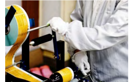
ラベル貼り作業
