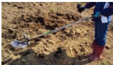
【図4-18：刈払機の操作の仕方】
