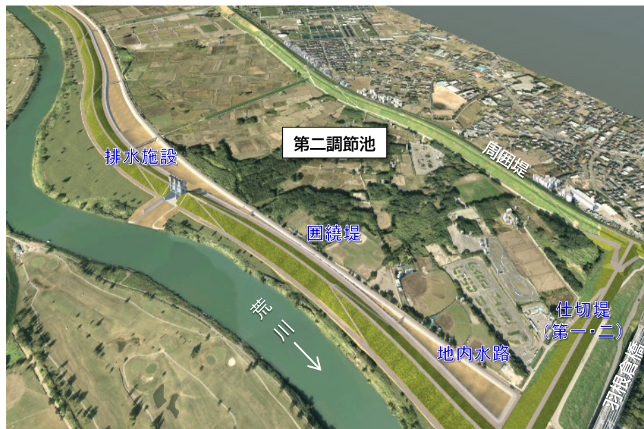
荒川第二調節池 完成形3Dモデル
