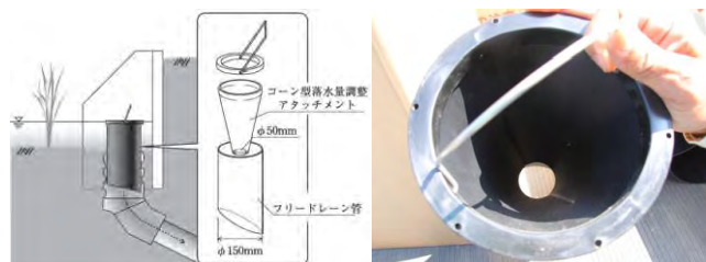
図 2-17 改良後の流出量調整器具（機能分離型）
