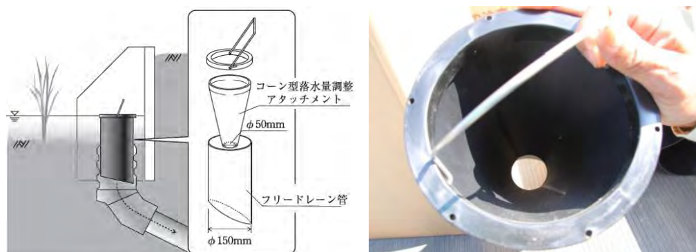
図 7-8 改良後の流出量調整器具（機能分離型）
