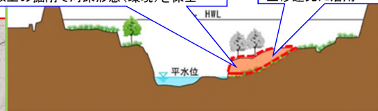
河道掘削（多自然川づくり）
