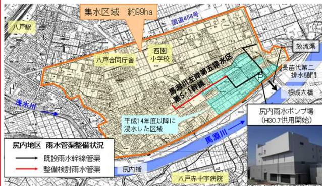
・下水道雨水幹線を整備し、過去に発生した大雨による浸水被害地区の再度災害防止を図る。
