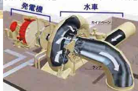
横軸単輪半流渦巻フランシス水車の内部構造図
