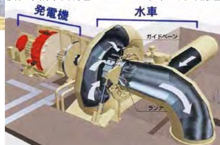
横軸単輪単流渦巻フランシス水車の内部構造図
