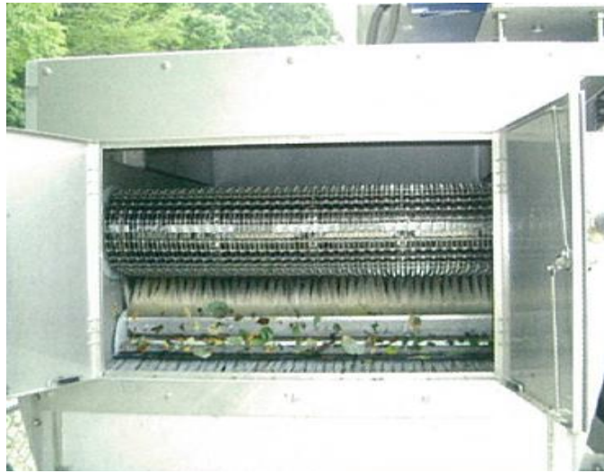
図 4-6 背面に設置された塵芥分離用のブラシ(写真提供：株式会社広洋技研)
