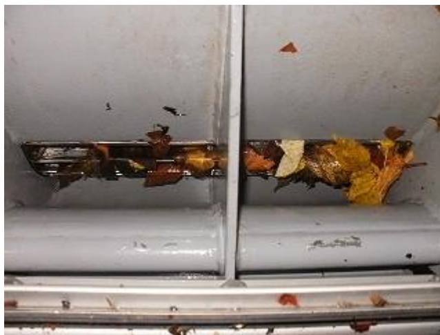
図 3-6 クロスフロー水車塵芥付着例(写真提供：東京発電株式会社)
