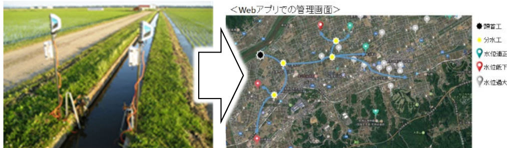
末端水路の水位のリアルタイムデータから用水需給バランスを把握
