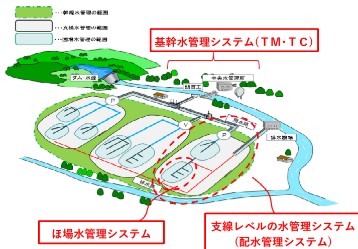
コラム図 2-1 次世代型水管理システムの概念図
