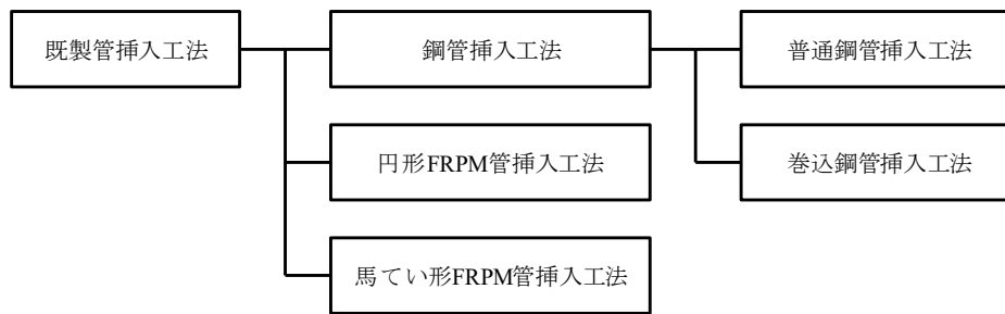
図-7.1.2 既製管挿入工法の分類
