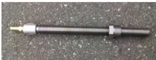
写真-8.5.7-7 空気抜き管（参考）
