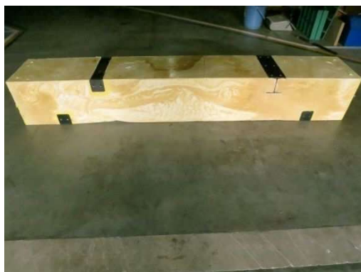
写真-2.2.3 充填確認状況 (1)
