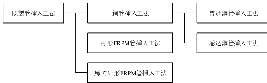
図-7.1.2 既製管挿入工法の分類
