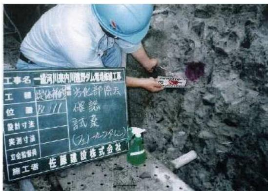
写真-巻-28 試薬検査状況
