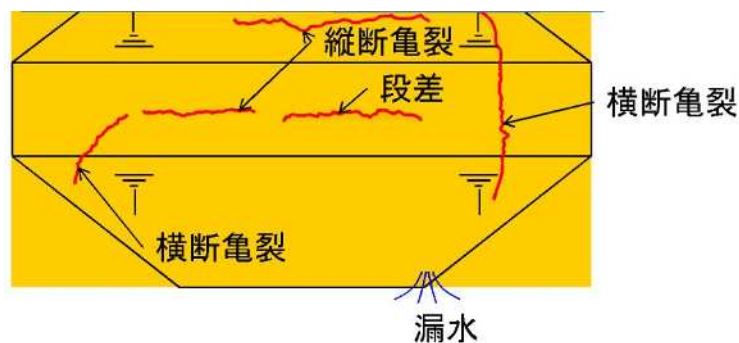
図-5.2-1 地震により発生する変状（亀裂・漏水等）
