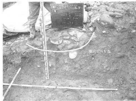
すべりはリップラップ材にある粘土層で発生
