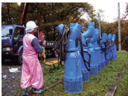
写真-巻-2 水中ポンプ（10 インチ）
