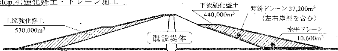
図一五 堤体強化工事 全体工程
