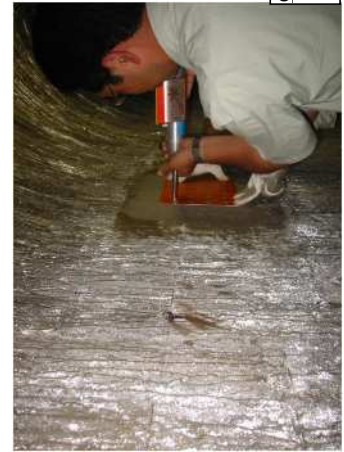
●テストハンマー(シュミットハンマー)の実施例 (打撃面は石などで研磨し平滑にする)： 写真は調査箇内での試験状況
