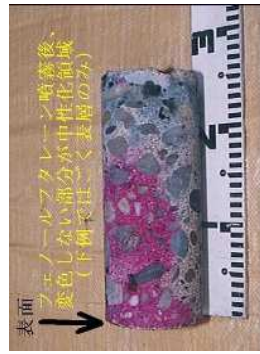
●コアの中性化試験の例(ダム)
