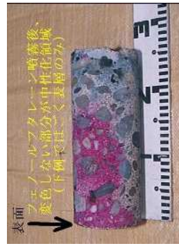
●コアの中性化試験の例(Aダム)
