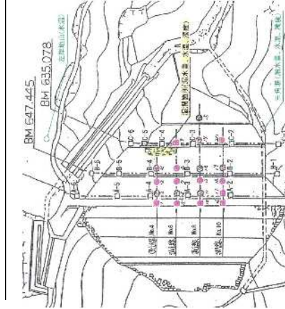
調査方法: 浸潤線計測孔を格子状に配置し、貯水位の変動に伴う堤体内浸潤線の挙動を図化整理している。
