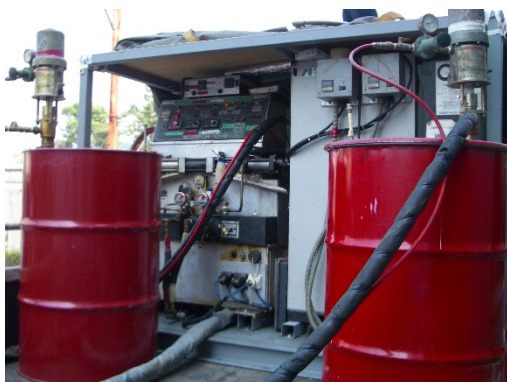
写真 5. 2. 4-5 吹付け用専用塗装機
