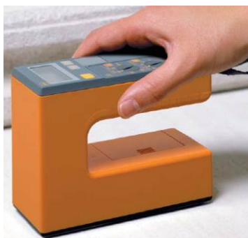
写真 11.5.1-6 高周波容量式水分計の例
