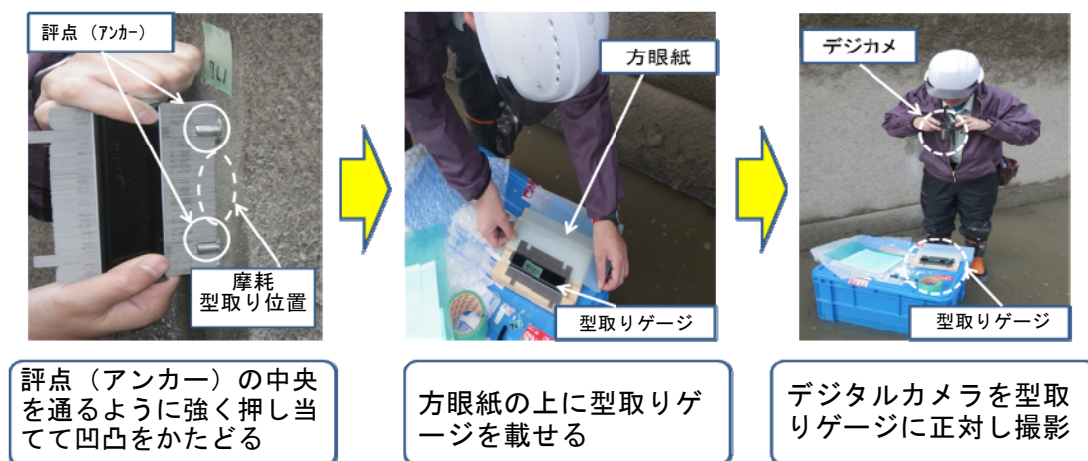
写真11.5.1-3 型取りゲージの型取り及び撮影
