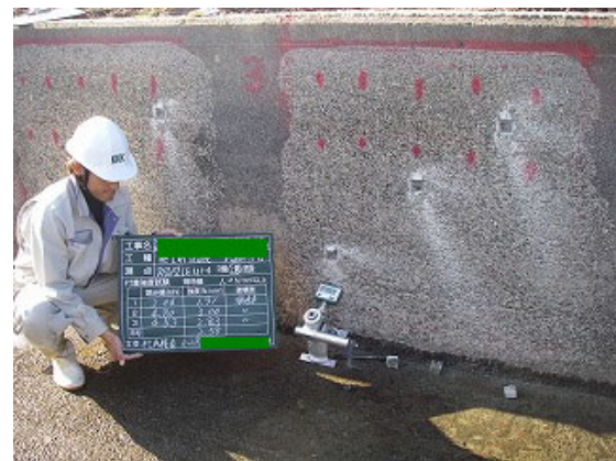
写真 4. 3. 2-4 試験状況(付着試験)
