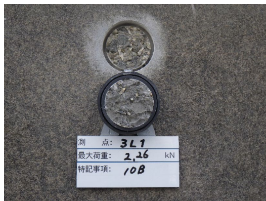
図 試験後の母材側及び付着ジグ側の写真撮影例
