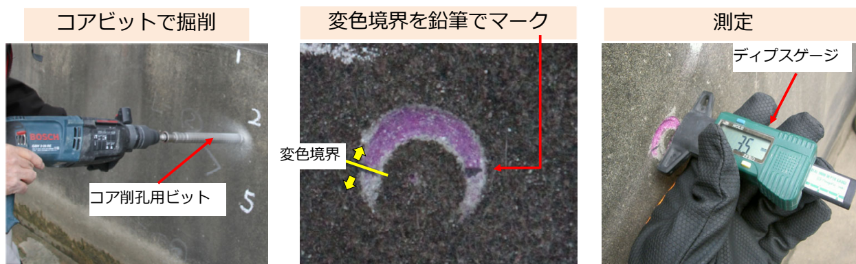
写真 11.5.1-5 小口径コア法の概要
