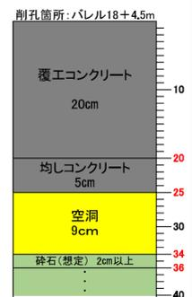
図 2.3-3 削孔による空洞確認
