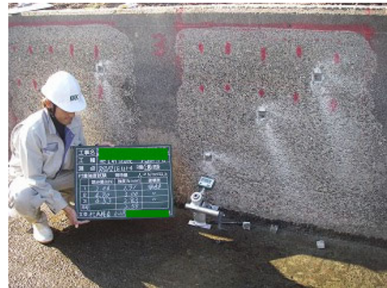
写真 4. 3. 2-4 試験状況(付着試験)
