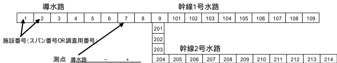
図-3.2.6 スパン番号等の記録例（管内での管内徒歩巡回目視の場合）
