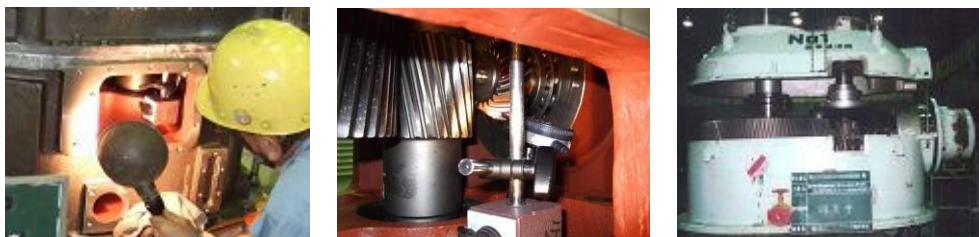
図 5.2.30 バックラッシの測定状況(例)
