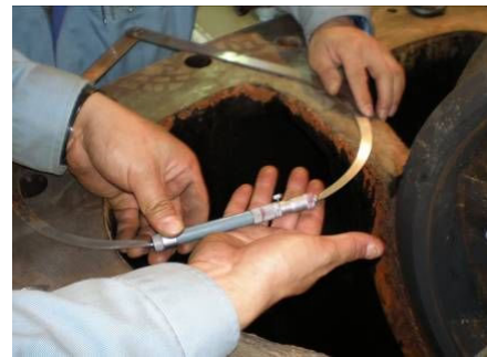
図 5. 2. 40 インサイドマイクロメータによる測定（例）
