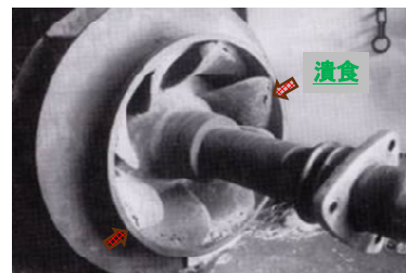
図 2.1.9 キャビテーションによるインペラの潰食状況
