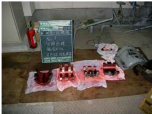
図 5.2.55 軸受メタルの浸透探傷試験（例）
