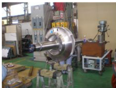
図 5.2.38 インペラ・ライナリング等の工場への持込状況
