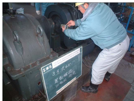
図 5.2.5 振動の測定（例）
