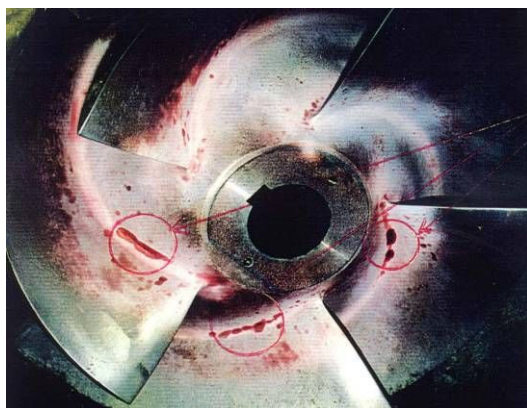
図 2.1.5 インペラの疲労き裂の例
