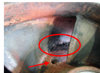
図 2.1.10 潰食により損傷したインペラ
