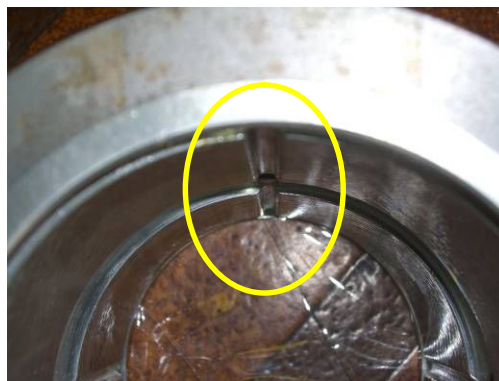
横軸軸流ポンプの水中軸受（新）
