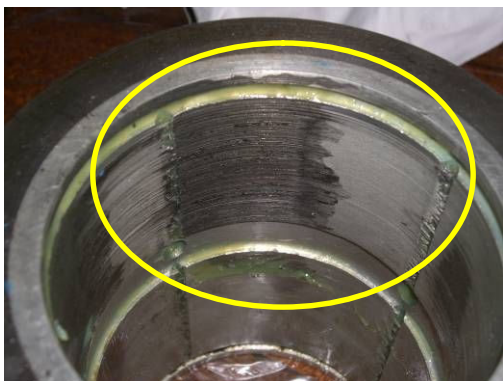
横軸軸流ポンプの水中軸受（旧）
