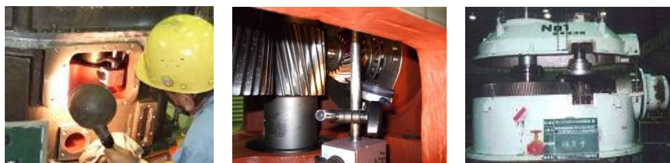
図 5. 2. 30 バックラッシの測定状況 (例)
