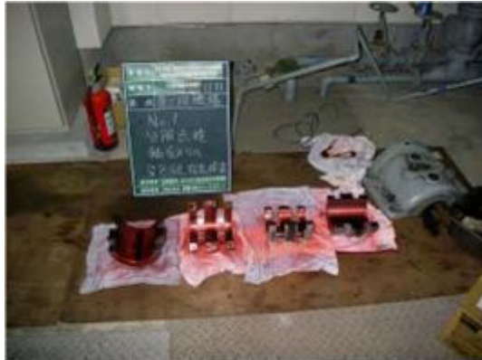
図 5.2.55 軸受メタルの浸透探傷試験（例）
