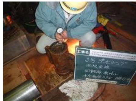
図 5.2.44 スリーブ軸受内径計測 (例)
