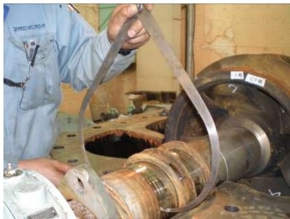
図 5. 2. 39 外パスによるスリーブ外径測定（例）
