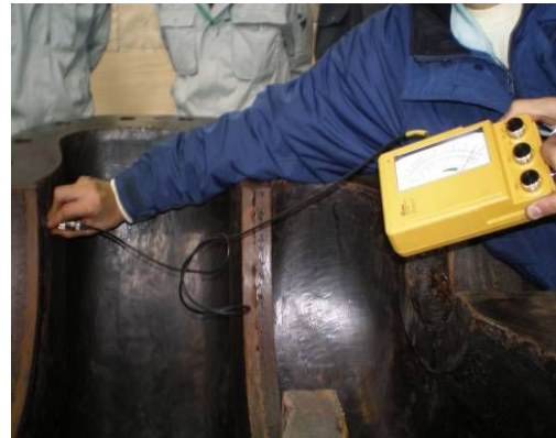
図 5.2.27 塗膜の測定（例）
