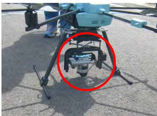
写真 参5-1 カメラを搭載したUAVの例
