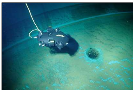
写真 参5-2 水中ロボットの活用事例
