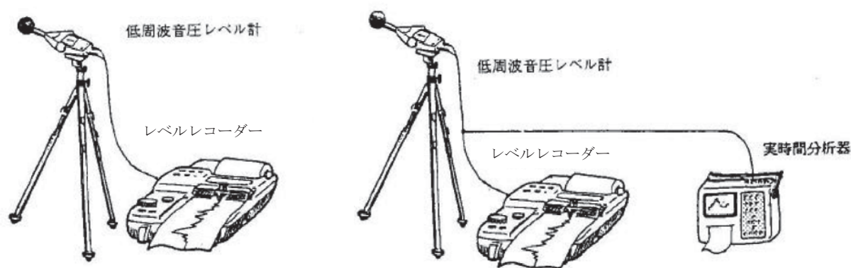
図-1 調査機器の設置例
