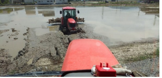
湿潤箇所にはまったトラクターを別のトラクターで牽引している様子
