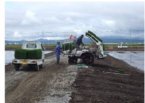
路面高を低くして、登坂部を設置することによりターンの農道としても利用
